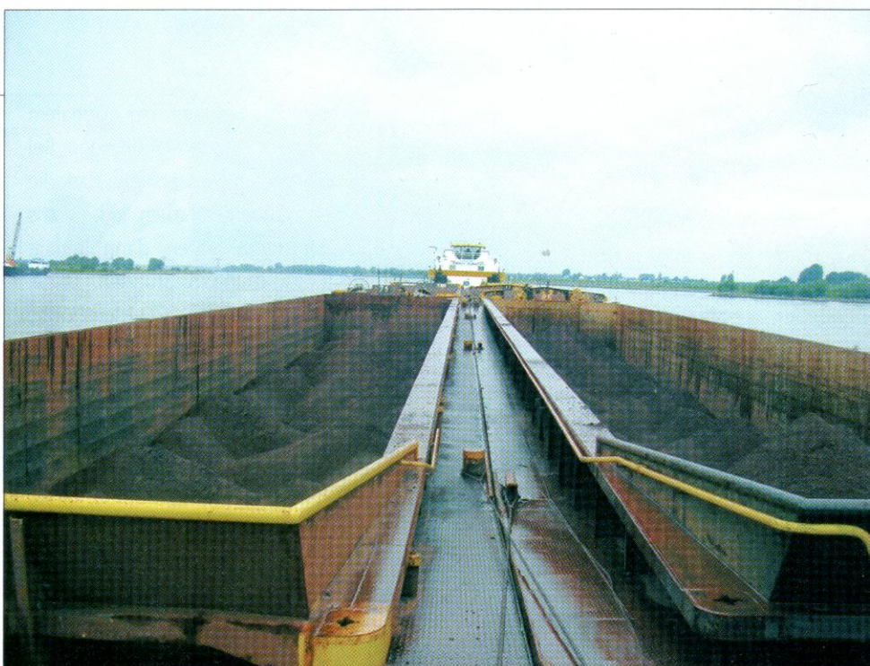
Pro Leichter können bis zu 2.800 Tonnen Eisenerz transportiert werden
